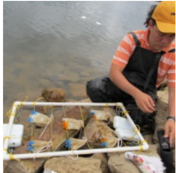
Figura 4. Soportes de PVC utilizados para mantener las bolsas de malla con las esferas en cada uno de los ambientes evaluados/ Foto: Alfonso Pineda.
